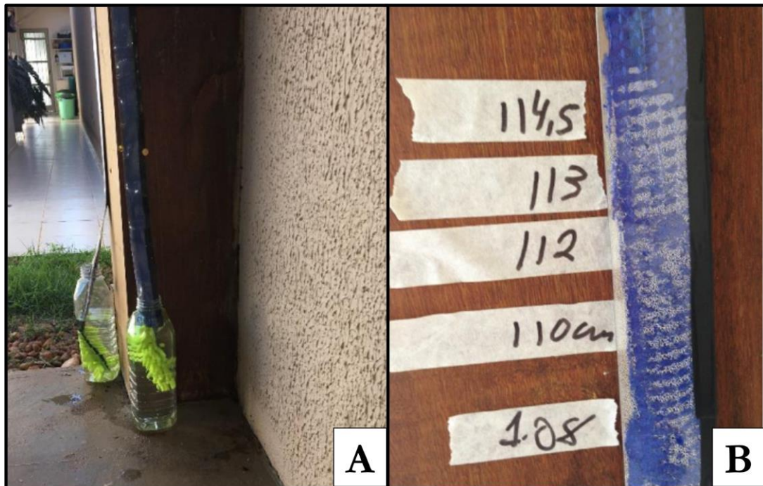
Figura 1. Teste realizado para seleção do material para produção do condutor de irrigação passiva. A - fita disposta verticalmente com a extremidade inferior submersa em água. B - altura atingida pela água.
