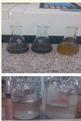
Figura 3. A) Residuo líquido industrial en contacto directo con los carbones activados CAC-773 y CAT-773 (izquierda y centro), el tercer matraz (derecha) contiene sólo el efluente evidenciando el color residual después del tratamiento biológico; B) efluente después del tratamiento fisicoquímico con CAC-773 (izquierda) y CAT-773 (derecha).
